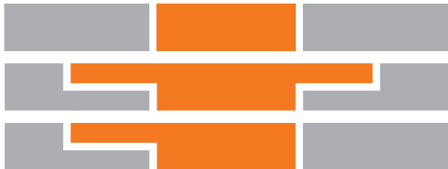
Figuur 9: Open, geen belemmering voor het (tussentijds) uitnemen van producten of elementen.
